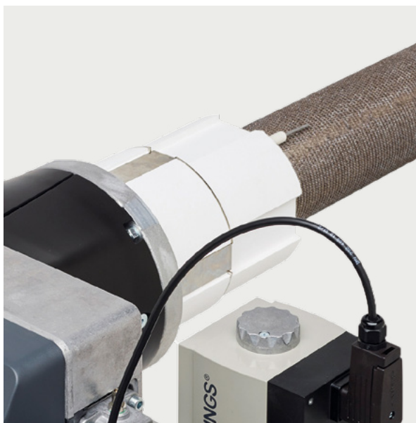
Der standardmäßig integrierte Isolator schützt die Vormischkammer, in der sich das zündfähige Brennstoff-Luft-Gemisch befindet, vor thermischer Belastung. Dies ist ein entscheidender Sicherheitsaspekt dieser Brennertechnologie.
